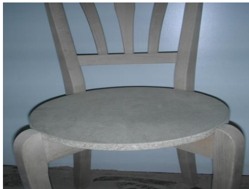
Picture 2.1: Dolu telora tablası
